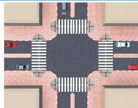
les traversées piétonnes doivent être dans l'axe des trottoirs
